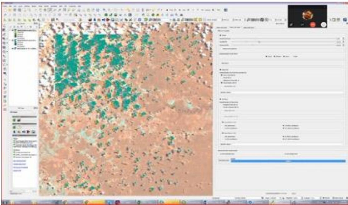
Figura 3 Imagen con máscara de nube QGIS aplicada durante la etapa de preprocesamiento. Se aplican filtros adicionales después de esta etapa para eliminar cualquier cubierta de nube adicional antes de los siguientes pasos de procesamiento.
