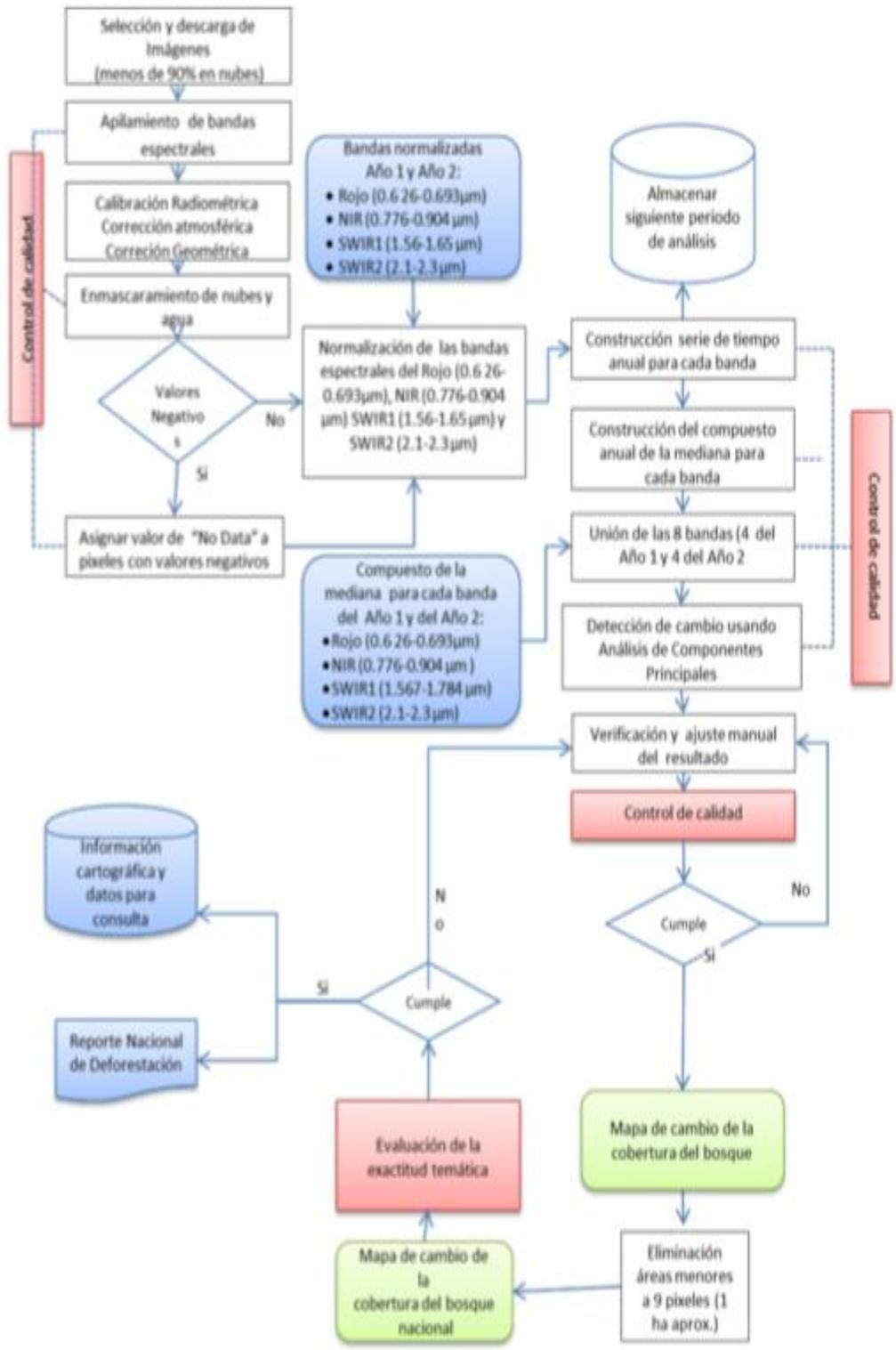
**Figura 1** Diagrama de flujo de trabajo del componente de procesamiento de imágenes de satélite (que representa la Fase 1-2) de la metodología FREL general (Fase 1-2).
