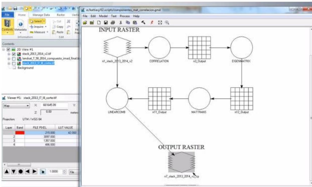
Figura 5 Modelo PCA implementado en ERDAS Imagine utiliza una matriz de correlación de la pila de 8 bandas
