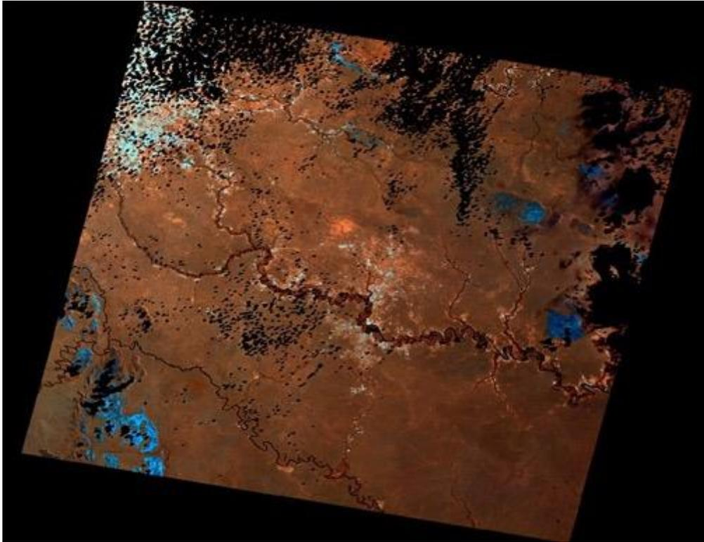
Figura 4 Imagen reflectante con 4 bandas, luego de aplicar la máscara de nube. Resaltan los polígonos sin datos.
