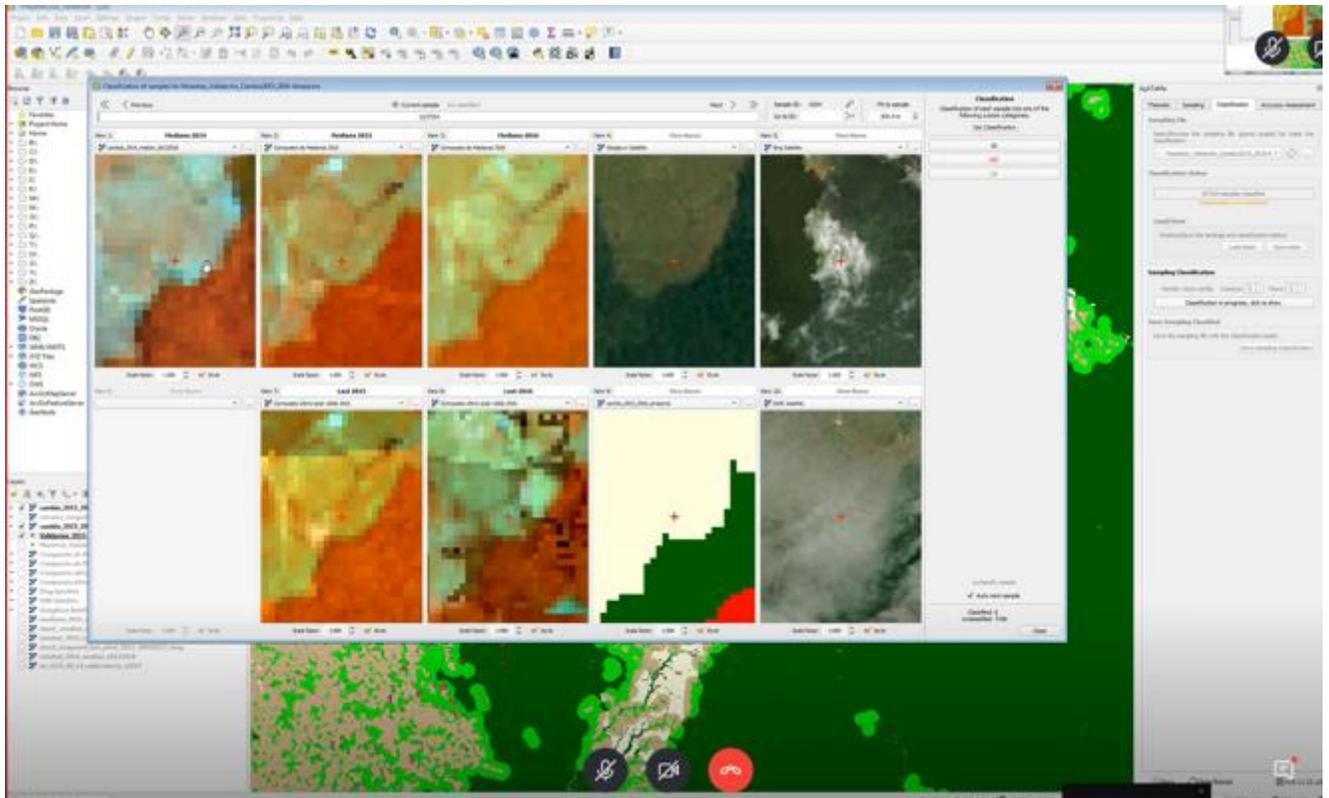
Figura 8 Evaluación de control de calidad dentro de ACATAMA que se utiliza para muestrear puntos aleatoriamente y confirmar el tipo de cobertura asignada al punto seleccionado. Este procedimiento da como resultado una matriz de errores y estadísticas de confianza. El proceso es iterativo.
