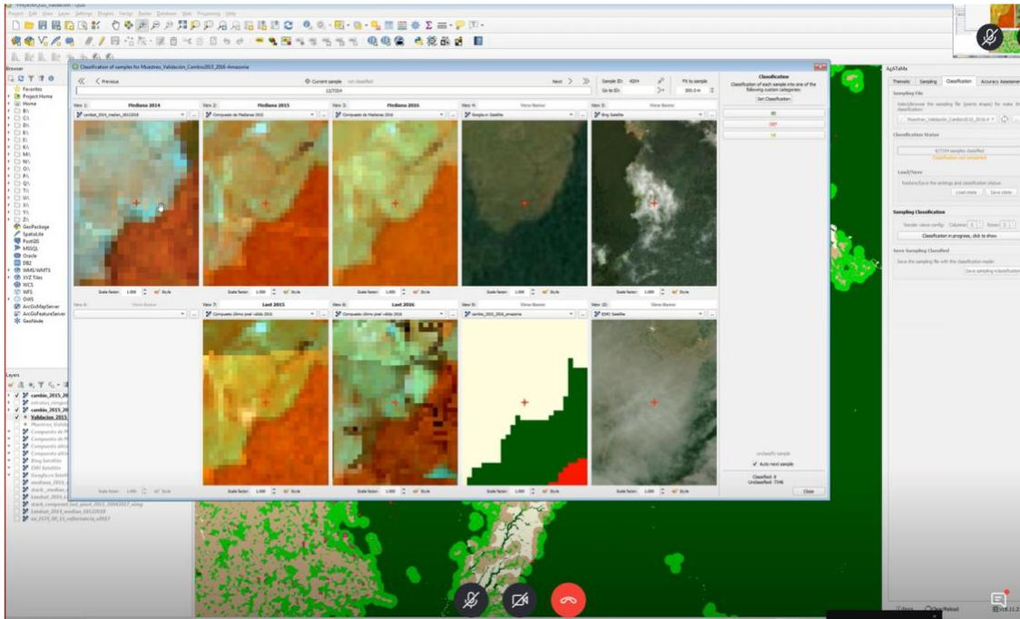
Figura 11 Sample Point Viewer de puntos de muestra en ACATAMA usando ventanas definidas por el usuario para datos de fuente de imagen.
