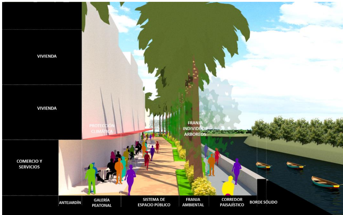
FIGURA 16. ELEMENTOS COMPLEMENTARIOS PARA LOS PERFILES CON BORDE HACIA LOS CUERPOS DE AGUA
