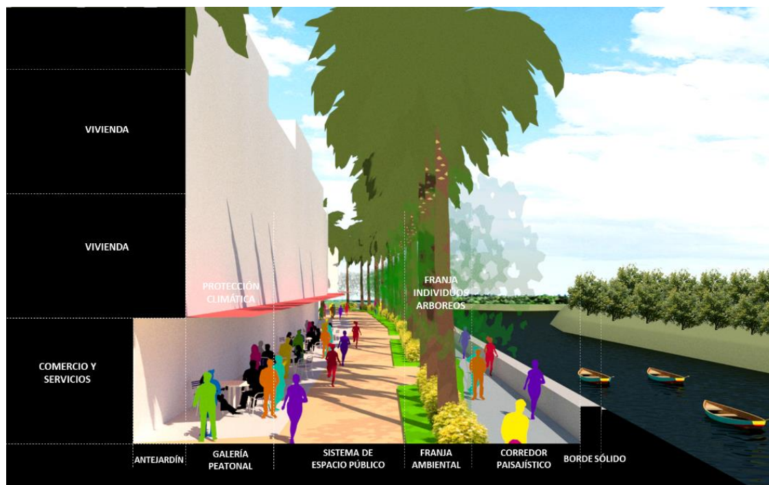
FIGURA 15. ELEMENTOS COMPLEMENTARIOS PARA LOS PERFILES CON BORDE HACIA LOS CUERPOS DE AGUA
