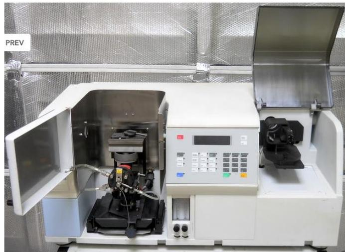
**Figura 6.** MHS-15 sistema de mercurio-hidruro.
